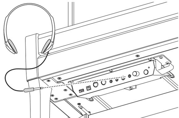
Wenn ein Kopfhörer angeschlossen ist, werden automatisch die Lautsprecher des NV5 abgeschaltet. Zusätzlich erscheint ein Kopfhörer Symbol in der Status Leiste des Displays.
