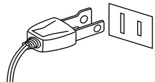
**Este producto debe estar cerca de una salida AC y el cable de corriente enchufado en una posición de tal forma que pueda desconectarse en caso de emergencia ya que la electricidad siempre esta en carga mientras la clavija esté enchufada en la salida AC incluso si el aparato está apagado.**
