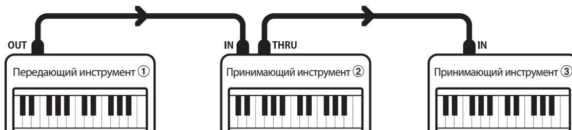
Передающий инструмент ① передает принимающим инструментам ②/③ информацию о канале передачи и действиях с клавиатурой.
