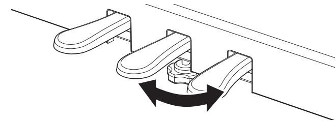
**Al mover el instrumento, siempre ajuste o gire el tornillo que apoya la pedalera al suelo, luego reajústelo cuando el instrumento esté en su nueva posición.**
