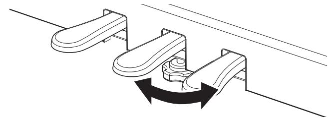
**Lorsque vous déplacez l'instrument, ajustez ou enlevez toujours la vis de support de pédales, puis réajustez-la lorsque l'instrument est dans sa nouvelle position.**
