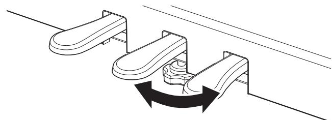
**Wenn das Instrument bewegt wird, drehen Sie die Schraube immer ganz rein oder schrauben Sie sie ganz ab. Wenn das Instrument an einem neuen Platz aufgestellt wird, stellen Sie die Einstellschraube wieder so ein, dass sie den Fußboden fest berührt.**
