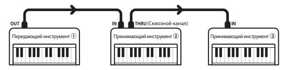
Передающий инструмент 1 передает принимающим инструментам 2/3 информацию о канале передачи и действиях с клавиатурой.
