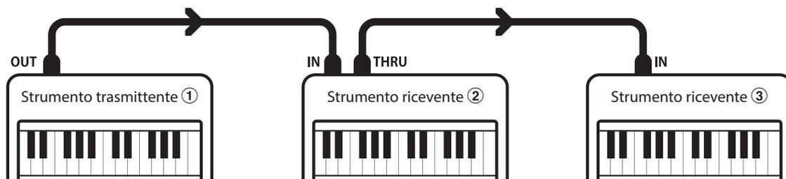
L'apparecchiatura trasmittente ① invia il canale di trasmissione e le informazioni della tastiera agli strumenti riceventi ②/③. Le informazioni arrivano agli strumenti riceventi ②/③.
