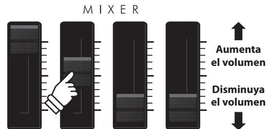
\* Cuando se selecciona el modo de órgano de ruedas fónicas y la pantalla de edición de sonido se muestra en la pantalla LCD, estos faders de VOLUME se utilizan para ajustar las posiciones de las barras deslizantes del órgano. Para obtener más información, consulte la página 32.
