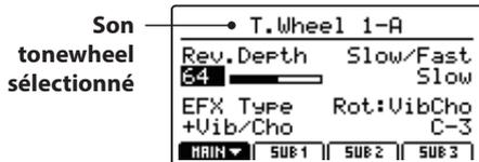
\* Le mode tonewheel ne peut être sélectionné que pour la zone MAIN. Lorsqu'une zone SUB est sélectionnée et que les boutons DRAWBAR 1/2/3 sont actionnés, une fenêtre de rappel apparaîtra et le son sélectionné restera inchangé.
