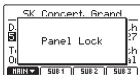
De forma predeterminada (modo Panel Lock), la función Lock bloquea todos los botones, mandos y faders de volumen de sección del panel del MP7SE, para impedir que se realicen ajustes involuntariamente durante, por ejemplo, una actuación.
