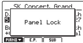
Par défaut (mode Panel Lock), la fonction Lock verrouillera tous les boutons, les boutons rotatifs et les atténuateurs VOLUME de la section du panneau du MP11SE afin d'éviter tout réglage accidentel pendant les interprétations, etc.
