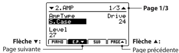
Tournez les boutons rotatifs de contrôle (A, B, C) pour modifier le type d'amplificateur, et régler les paramètres d'excitation et de niveau.
