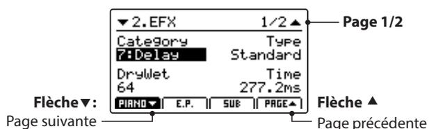
Tournez les boutons rotatifs de contrôle (A, B, C, D) pour modifier la catégorie, le type d'effet, et pour régler les paramètres d'effet supplémentaires.
