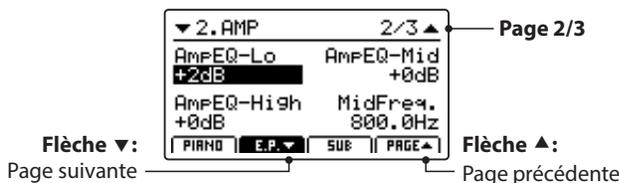
Tournez les boutons rotatifs de contrôle (A, B, C, D) pour régler les paramètres Lo, Mid, Hi et MidFreq EQ du simulateur d'amplificateur.
