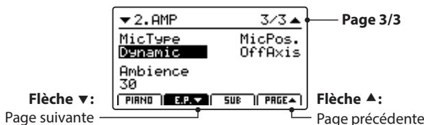
Tournez les boutons rotatifs de contrôle (A, B, C) pour modifier le type et la position du microphone du simulateur d'amplificateur, et pour régler le paramètre d'ambiance.
