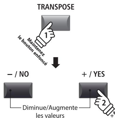
**Exemple :** Pour augmenter le ton du clavier de 4 demi-tons, appuyez sur le bouton TRANSPOSE et maintenez-le enfoncé, puis appuyez sur le bouton +/YES quatre fois.
