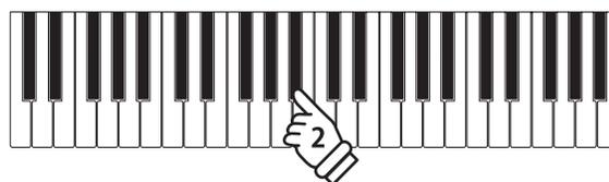
*Exemple : Pour réduire le ton du clavier de 2 demi-tons, appuyez sur le bouton TRANSPOSE et maintenez-le enfoncé, puis appuyez sur la touche B<sup>b</sup> la plus proche de la touche Do du milieu.*
