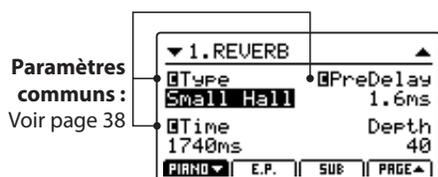
Tournez les quatre boutons rotatifs de commande (A, B, C, D) pour changer le type de réverbération et régler des paramètres de réverbération supplémentaires.
