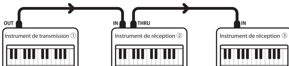
Instrument transmetteur ① envoie des informations de canal de transmission et clavier à des instruments récepteurs ②/③. Les informations arrivent aux instruments récepteurs ②/③.
