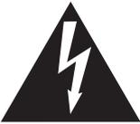
Si se enciende el símbolo de un rayo de un triángulo, alerta al usuario de la presencia de "voltaje peligroso" no protegido dentro del producto, indicando suficiente magnitud para constituir riesgo de descarga eléctrica.
