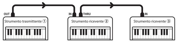
L'apparecchiatura trasmittente 1 invia il canale di trasmissione e le informazioni della tastiera agli strumenti riceventi 2/3. Le informazioni arrivano agli strumenti riceventi 2/3.
