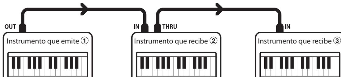
El instrumento que emite ① envía información del canal y del teclado a los instrumentos que reciben ②/③. La información llega a los instrumentos que reciben ②/③.
