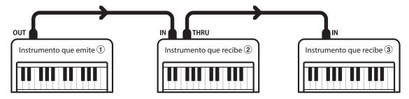
El instrumento que emite 1 envía información del canal y del teclado a los instrumentos que reciben 2/3. La información llega a los instrumentos que reciben 2/3.
