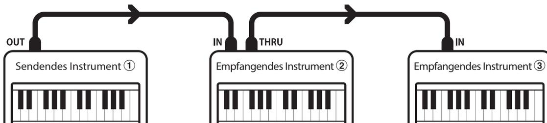
Das Instrument ① sendet seine Kanal- und Tastaturinformationen auf dem eingestellten Sendekanal an die empfangenden Instrumente ②/③.
