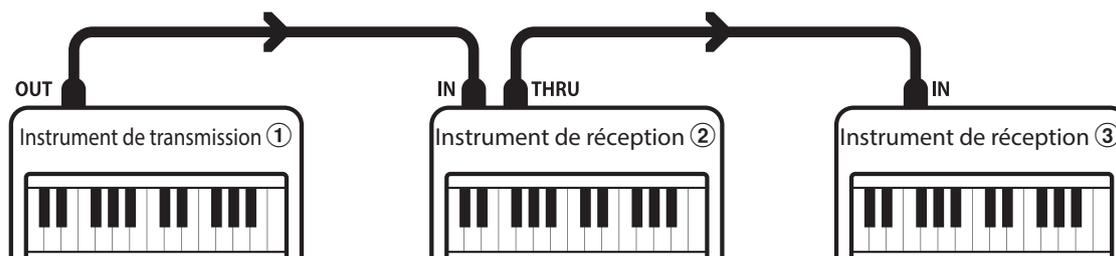
Instrument transmetteur ① envoie des informations de canal de transmission et clavier à des instruments récepteurs ②/③.
