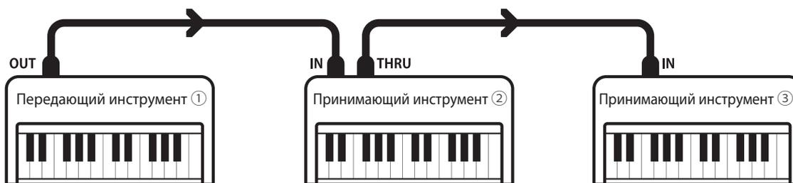
Передающий инструмент ① посылает информацию с клавиатуры принимающим инструментам ② и ③. Информация приходит принимающим инструментам ② и ③. Инструменты ② и ③ отреагируют на присылаемые команды MIDI, если их принимающие каналы соответствуют каналам передающего инструмента ①. Если каналы не соответствуют друг другу, инструменты ② и ③ не отреагируют на присылаемые команды MIDI.
