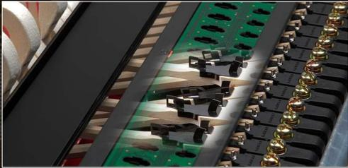
I movimenti del martello della tastiera dei pianoforti AR2 e ATX4 sono misurati con il sistema IHSS (Integrated Hammer Sensing System) di Kawai, che utilizza sensori ottici ad alta risoluzione per fornire una maggiore precisione rispetto ai sistemi convenzionali basati sui tasti.
