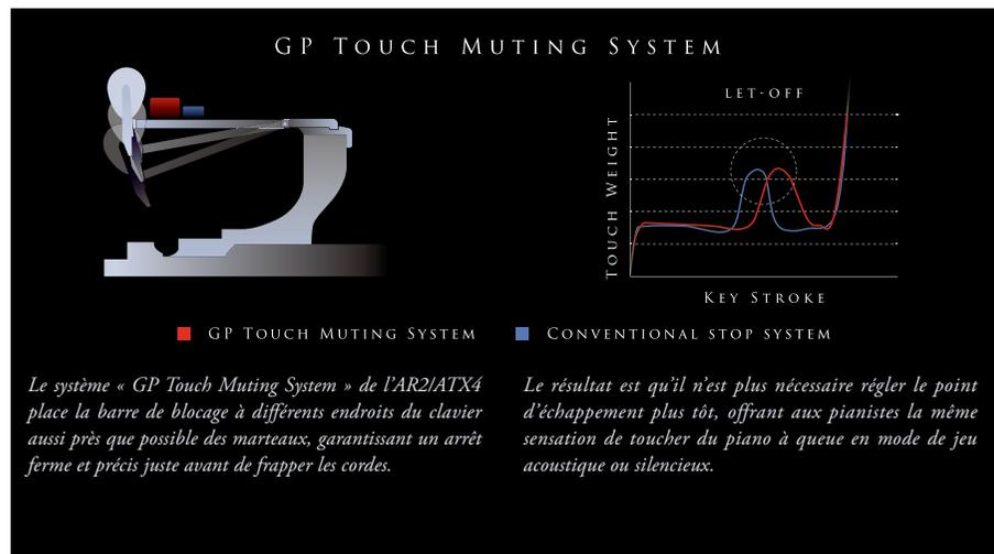
Les mouvements précis des marteaux des pianos AR2 et ATX4 sont mesurés à l'aide du système de capteurs optiques haute résolution sans contact Kawai IHSS (Integrated Hammer Sensing System). Une technologie bien plus précise que les systèmes conventionnels de détection basés sous les touches.
