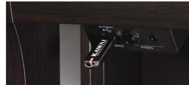
Cette fonction *USB to Device* permet de sauvegarder sur des dispositifs USB des paramètres de l'instrument, des enregistrements et des morceaux enregistrés dans la mémoire interne ou de télécharger des fichiers MIDI standard (SMF) afin de les écouter, sans matériel supplémentaire, grâce aux sonorités de l'*Harmonic Imaging XL*.
