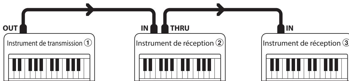
Instrument transmetteur ① a envoi des informations de canal de transmission et clavier à des instruments récepteurs ②/③. Les informations arrivent aux instruments récepteurs ②/③. Instruments récepteurs ②/③ répondent aux données MIDI qui sont envoyées si leur canal de réception est identique au canal de transmission de l'instrument transmetteur ①. Si les canaux ne correspondent pas, les instruments récepteurs ②/③ ne répondent pas aux données envoyées.
