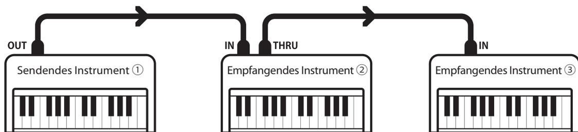
Das Instrument ① sendet seine Kanal- und Tastaturinformationen auf dem eingestellten Sendekanal an die empfangenden Instrumente ②/③.
