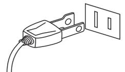
**Stellen Sie das Instrument in der Nähe Steckdose auf und vergewissern Sie sich, dass der Netzstecker für den Fall erreichbar ist, dass er schnell abgezogen werden kann. Solange der Netzstecker nicht abgezogen ist, steht das Netzteil unter Strom auch wenn Instrument ausgeschaltet wurde.**
