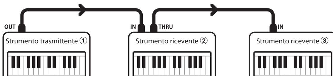
L'apparecchiatura trasmittente ① invia il canale di trasmissione e le informazioni della tastiera agli strumenti riceventi ②/③.
