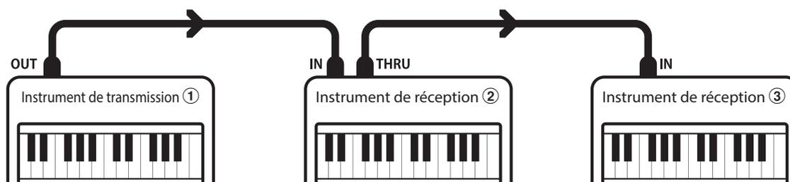
Instrument transmetteur ① envoie des informations de canal de transmission et clavier à des instruments récepteurs ②/③. Les informations arrivent aux instruments récepteurs ②/③.
