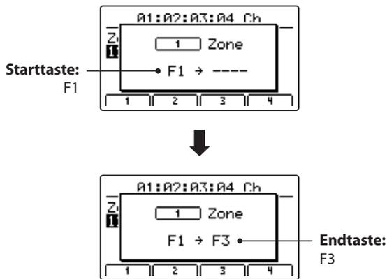
\* Zur Einstellung des gesamten Tastaturbereiches halten Sie die ZONE Taste gedrückt und schlagen die tiefste und höchste Note an.
