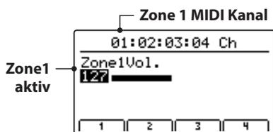
Dies ist der MIDI Zone Lautstärke Bildschirm, der automatisch angezeigt wird, wenn eine Zone eingeschaltet wird.
