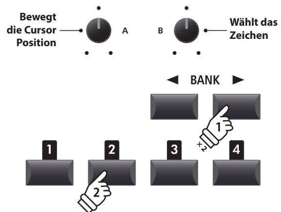
Beispiel: Zur Auswahl von SETUP Speicher C-2 drücken Sie die Taste BANK ▶ zweimal und dann die Speichertaste 2.
