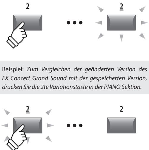
Beispiel: Zum Vergleichen der geänderten Version des EX Concert Grand Sound mit der gespeicherten Version, drücken Sie die 2te Variationstaste in der PIANO Sektion.
