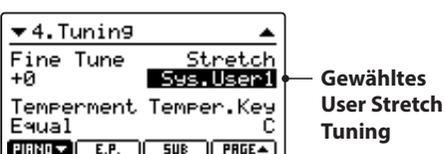
\* Um sicherzustellen, dass das erzeugte User Stretch Tuning bei Anwahl des Sounds automatisch verwendet wird, nutzen Sie die SOUND-Speicherfunktion.
