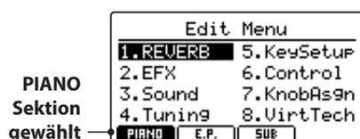
\* Zum Ändern der Sektion drücken Sie eine der Tasten F1~F3.
