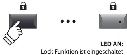
Im Standard (Panel Lock Modus) blockiert die Lock-Funktion alle Bedienfeldtasten, Drehregler und Sektions-Lautstärkereger des MP11SE, um ein unbeabsichtigtes Verstellen während des Musizierens zu verhindern.
