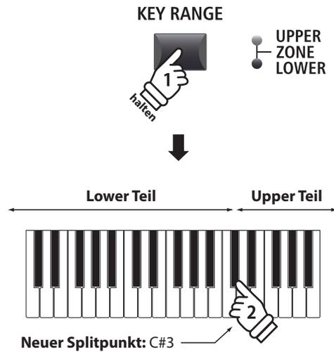
Beispiel: Um den Splitpunkt auf C#3 zu setzen, halten Sie die Taste KEY RANGE und schlagen die Note C#3 an.
