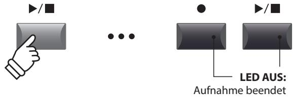
\* Drücken Sie die Tasten ● und ▶/■ gleichzeitig kann die Aufnahme gelöscht werden.
