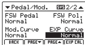
Drücken Sie die Funktionstaste F4 (EXP CAL) wird der Bildschirm zur Kalibrierung angezeigt.
