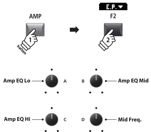
Drehen Sie die Regler (A, B, C, D) zum Einstellen der Amp Simulator Parameter Lo, Mid, Hi und MidFreq EQ.
