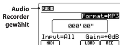
\* Falls der MIDI Recorder Bildschirm angezeigt wird, drücken Sie bitte die Funktionstaste F1 (AUDIO) zum Umschalten auf den Audio Recorder.
