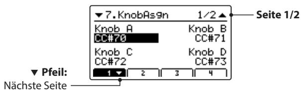
Drücken Sie die Tasten F1~F4 (abhängig von der gewählten MIID Zone) zum Anzeigen der zweiten Gruppe von Regler Parametern.
