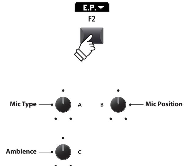
Drehen Sie die Regler (A, B, C) zum Einstellen des Mikrofon Typs und der Position des Mikrofons sowie der Ambience Mikrofone.
