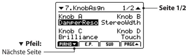
Drücken Sie die Tasten F1~F3 (abhängig von der gewählten Sektion) oder die CURSOR ▲▼ Tasten zum Anzeigen der zweiten Gruppe von Regler Parametern.
