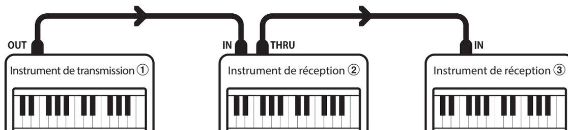
L'instrument de transmission ① envoie des informations de canal de transmission et de clavier aux instruments de réception ②/③. L'information arrive aux instruments de réception ②/③.
